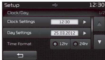
Diese Funktion wird verwendet, um das Uhrformat zwischen 12 Stunden und 24 Stunden umzuschalten.
