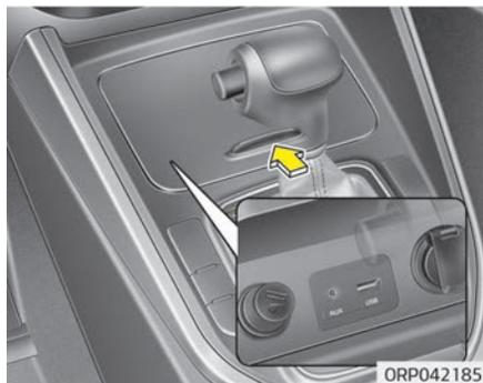
Sie können Audiogeräte an den AUX-Anschluss anschließen, der USB-Anschluss ist für USB-Geräte und iPods® vorgesehen.
