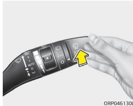
Drücken Sie den Hebel von Ihnen weg, um Waschwasser auf die Heckscheibe zu sprühen und die Heckscheibenwischer 1 – 3 Mal wischen zu lassen. Der Sprüh- und Wischvorgang wird fortgesetzt, bis Sie den Hebel freigeben.
