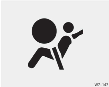
Die Airbag-Warnleuchte im Kombiinstrument soll Sie warnen, wenn mögliche Probleme mit Ihren Airbags - SRS-System (ergänzendes Rückhaltesystem) - auftreten.
