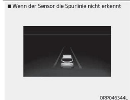
Wenn Ihr Fahrzeug die Spur bei aktiviertem LDWS und einer Fahrzeuggeschwindigkeit von mehr als 60 km/h verlässt, erfolgt die Warnung wie folgt:
