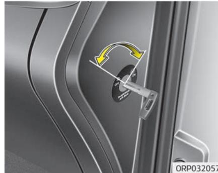
Wenn ein Kinderrückhaltesystem auf dem Beifahrersitz installiert ist oder wenn dieser Sitz nicht besetzt ist, kann der Beifahrerairbag mit dem Schalter "Beifahrer-Frontairbag ON/OFF" deaktiviert werden.
