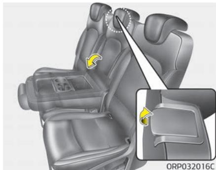
1. Schieben Sie die Kopfstütze bis in die tiefste Position nach unten.
