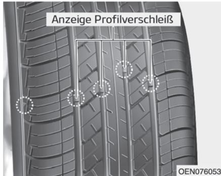
Bei gleichmäßigem Reifenverschleiß erscheint mit der Zeit eine Verschleißanzeige über die Breite der Lauffläche. Sie zeigt an, dass die verbleibende Profiltiefe weniger als 1,6 mm beträgt. Ersetzen Sie den Reifen, sobald dies der Fall ist.
