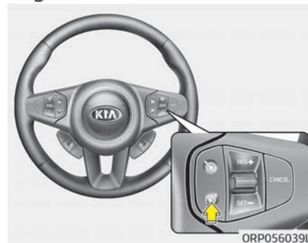
1. Drücken Sie die Höchstgeschwindigkeitstaste
