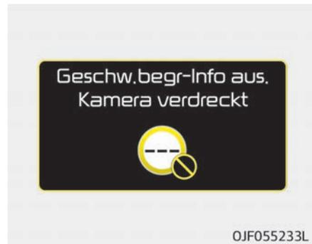
Die Meldung erscheint, wenn das Kamerasichtfeld durch Objekte verdeckt wird. Das System stoppt solange, bis das Sichtfeld wieder normal ist. Prüfen Sie die Windschutzscheibe um die Kameralinse.
