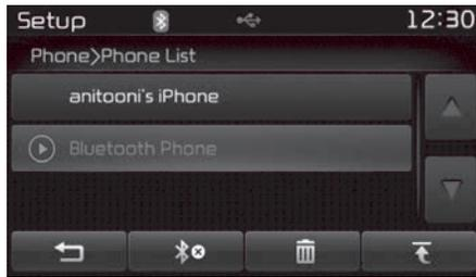
Wählen Sie aus der Liste der gekoppelten Telefone das aktuell verbundene Gerät aus, und drücken Sie die Taste **Bluetooth**.
