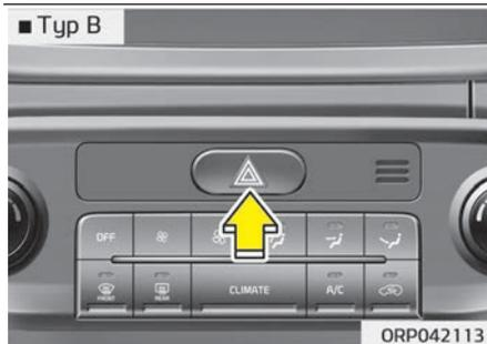
Sie sollte verwendet werden, wenn Notreparaturen durchgeführt werden oder wenn das Fahrzeug am Straßenrand angehalten wurde.
