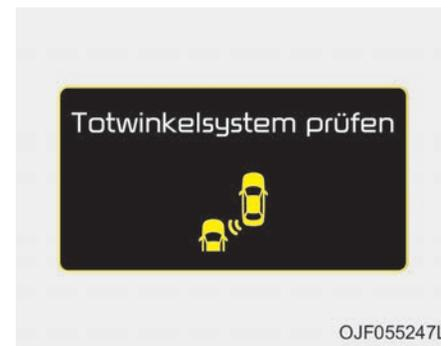
Wenn das System nicht ordnungsgemäß funktioniert, erscheint eine Warnmeldung und das Licht auf dem Schalter erlischt. Das System schaltet sich automatisch aus.
