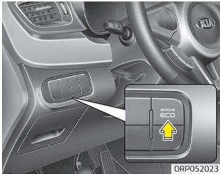
Durch den aktiven ECO-Betrieb können Sie Kraftstoff sparen, indem Sie Motor und Getriebe regeln. Der Umfang der Kraftstoffeinsparung hängt vom Fahrstil des Fahrers und den Straßenbedingungen ab.
