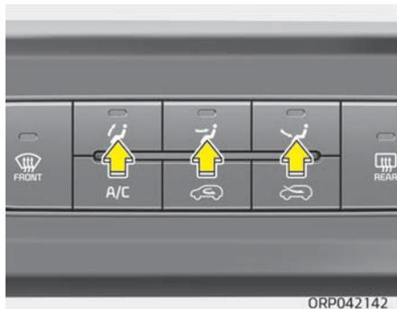
Die Modustasten steuern die Richtung des Luftstroms im Belüftungssystem. Die Luft kann in den Fußraum, zu den Düsen im Armaturenbrett und zur Windschutzscheibe geleitet werden. Es werden drei Symbole für die Darstellung der Lüftungsmodi Kopfbereich, Fußraum und Windschutzscheibe verwendet.
