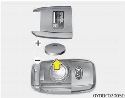
1. Schieben Sie ein kleines Werkzeug in den Schlitz und hebeln Sie die Abdeckung der Fernbedienung vorsichtig auf.
