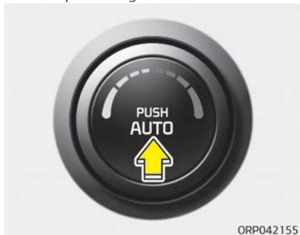
1. Drücken Sie die AUTO-Taste. Lüftungsmodi, Gebläsedrehzahl, Frischluft-/Umluftschaltung und die Klimaanlage werden automa-
