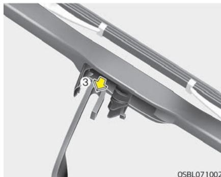
4. Drücken Sie den Wischerarm (3) nach unten und installieren Sie das neue Wischerblatt in umgekehrter Reihenfolge des Ausbaus.
