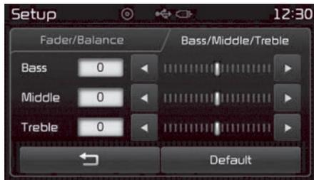
Verwenden Sie die Tasten **◀**, **▶**, **▲**, **▼**, um Fader/Balance einzustellen. Verwenden Sie die Tasten **◀**, **▶**, um Tiefen/Mitten/Höhen einzustellen. Zum Zurücksetzen drücken Sie die Taste **Default**.
