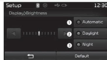
Verwenden Sie die Tasten **◀**, **▶**, um die Bildschirmhelligkeit anzupassen oder die Helligkeit auf den Modus "Automatic" (Automatisch), "Day" (Tag) oder "Night" (Nacht) einzustellen. Zum Zurücksetzen drücken Sie die Taste **Default**.
