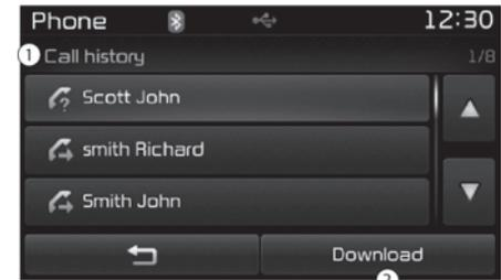
Eine Liste der eingegangenen, ausgegangenen und verpassten Anrufe wird angezeigt.
