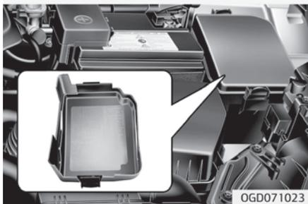
■ Sicherungskasten im Motorraum (für Dieselmotor)
