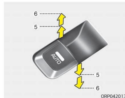
Wenn Sie die Schaltertaste kurzzeitig bis in die zweite Rastung (6) niederdrücken oder ziehen, öffnet oder schließt sich das Fenster vollständig, auch wenn der Schalter wieder losgelassen wird. Um das Fenster in der gewünschten Position zu stoppen, ziehen Sie den Schalter nach oben oder drücken ihn nach unten und lassen ihn dann los.
