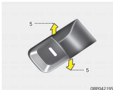
Um ein Fenster zu öffnen oder zu schließen, drücken oder ziehen Sie das vordere Ende der Schaltertaste bis zur ersten Raststufe (5).
