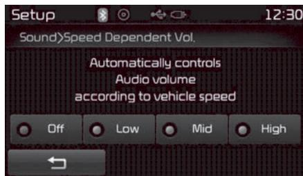
Die Lautstärke wird automatisch an die Geschwindigkeit des Fahrzeugs angepasst. SDVC können Sie durch Auswahl von Off/Low/Mid/High (Aus/Niedrig/Mitte/Hoch) auswählen.
