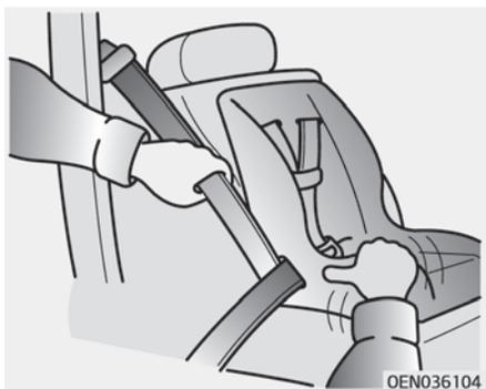
3. Schließen Sie den Sicherheitsgurt, so dass der Gurt straff an oder in dem Rückhaltesystem sitzt. Versuchen Sie nach dem Befestigen, den Kindersitz in alle Richtungen zu bewegen, um sicherzustellen, dass das Kinderrückhaltesystem sicher befestigt ist.
