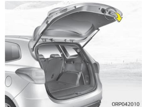
Drücken Sie die Heckklappe fest nach unten. Vergewissern Sie sich, dass die Heckklappe vollständig im Schloss eingerastet ist.
