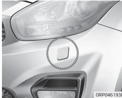
Wenn das Fahrzeug mit einer Scheinwerferwaschanlage ausgestattet ist, wird diese immer betätigt, wenn Sie die Waschanlage der Windschutzscheibe betätigen. Sie arbeitet, wenn der Scheinwerferschalter in der ersten oder zweiten Position steht und sich der Zündschlüssel bzw. der Knopf ENGINE START/STOP (Motorstartknopf) in Stellung ON befindet. Das Washwasser wird auf die Scheinwerfer gesprüht.
