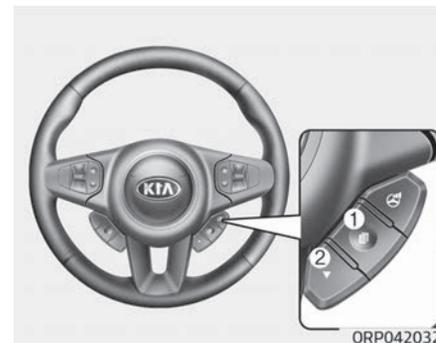
Die LCD-Display-Modi können mit den Steuertasten am Lenkrad verändert werden.
