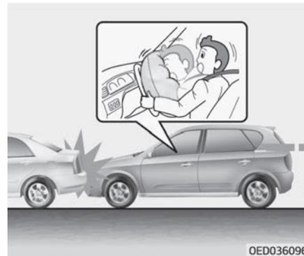
Frontairbags werden in der Regel bei einem Frontalaufprall ausgelöst. Die Auslösung hängt von der Intensität, der Geschwindigkeit und dem Aufprallwinkel ab.
