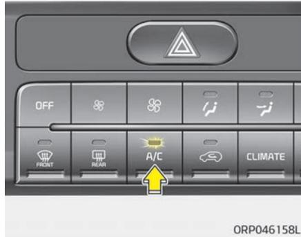
Drücken Sie die Taste A/C, um die Klimaanlage einzuschalten. Die Kontrollleuchte im Schalter leuchtet bei eingeschalteter Klimaanlage auf. Um die Klimaanlage abzuschalten, drücken Sie nochmals die Taste A/C.
