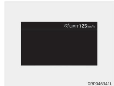
Die eingestellte Geschwindigkeitsbegrenzung wird angezeigt. Um über die voreingestellte Geschwindigkeitsbegrenzung zu fahren, müssen Sie das Gaspedal stärker betätigen (mehr als ca. 80 %), bis der Kick-down-Mechanismus durch ein Klickgeräusch aktiviert wird. Dann blinkt die eingestellte Höchstgeschwindigkeit und es ertönt ein Warnsignal, bis Sie wieder auf eine Geschwindigkeit unter der Höchstgeschwindigkeit zurückkehren.
