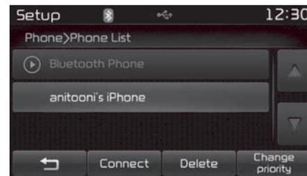
Wählen Sie aus der Liste der gekoppelten Telefone das Telefon aus, dem Sie die höchste Priorität zuordnen möchten, und drücken Sie die Taste **Change priority** im Menü. Dem ausgewählten Gerät wird die höchste Priorität zugeordnet.
