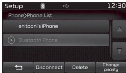
Wählen Sie aus der Liste der gekoppelten Telefone das Gerät aus, das Sie löschen möchten, und drücken Sie die Taste **Delete**.
