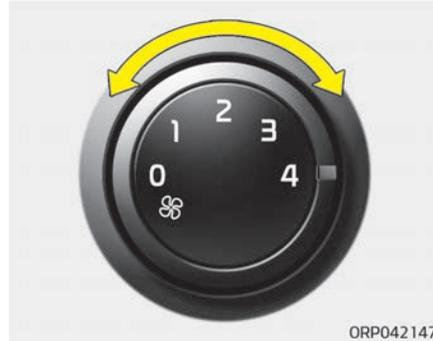
Das Gebläse kann nur bei eingeschalteter Zündung bedient werden. Mit diesem Drehknopf können Sie die Gebläsedrehzahl einstellen, um den aus den Luftdüsen strömenden Luftstrom zu regulieren. Um die Gebläsedrehzahl einzustellen, drehen Sie den Knopf nach rechts, um die Gebläsedrehzahl zu erhöhen oder nach links, um die Drehzahl zu verringern.
