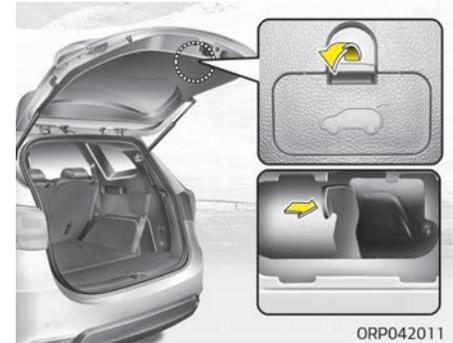
Ihr Fahrzeug ist mit einem Hebel für die Notentriegelung der Heckklappe ausgerüstet. Der Hebel befindet sich unten an der Heckklappe. Wenn eine Person versehentlich im Laderaum eingeschlossen wurde, kann sie die Heckklappe wie folgt entriegeln:
