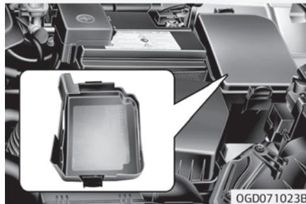
■ Sicherungskasten im Motorraum (nur Dieselmotor)
