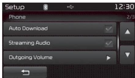
Mit dieser Funktion werden die Kontakteinträge automatisch heruntergeladen, sobald ein Bluetooth®-Telefon verbunden ist.
