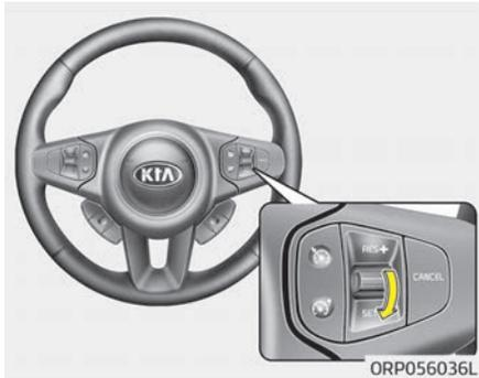
3. Drücken Sie den Hebel nach unten (in Richtung SET-) und lassen Sie ihn bei Erreichen der gewünschten Geschwindigkeit los. Die Tempomat-Kontrollleuchte leuchtet auf. Lassen Sie gleichzeitig auch das Gaspedal los. Die eingestellte Geschwindigkeit wird nun automatisch beibehalten.
