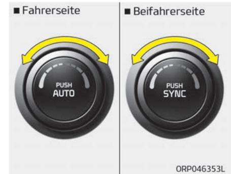
Durch Drehen des Temperaturreglers bis in die äußerste rechte Reglerstellung wird die maximale Temperatur (HI) erreicht.
