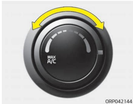
Der Temperaturregler erlaubt die Regelung der Temperatur des Luftstroms im Fahrzeug.
