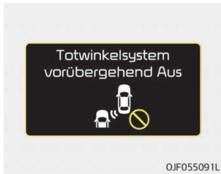
Die Meldung weist den Fahrer darauf hin, dass sich Fremdkörper auf dem bzw. im hinteren Stoßfänger befinden oder der Bereich am hinteren Stoßfänger heiß ist. Das Licht auf dem Schalter und das System schalten sich automatisch aus.
