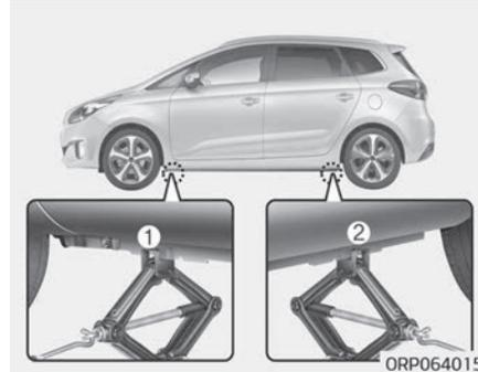
7. Stellen Sie den Wagenheber unter den vorderen (1) oder hinteren (2) Wagenheberaufnahme punkt neben dem zu wechselnden Rad. Stellen Sie den Wagenheber unter den entsprechenden Aufnahme punkt am Fahrzeugrahmen. Die Aufnahme punkte bestehen aus Metallplatten mit zwei Aussparungen und einem hervorstehenden zentralen Führungspunkt, der zu einer Aussparung im Wagenheber passt.
