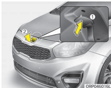
2. Stellen Sie sich vor das Fahrzeug, heben Sie die Motorhaube leicht an und ziehen Sie den Entriegelungshebel der zweiten Verriegelungsstufe (1) unter der Motorhaube nach oben und klappen Sie die Motorhaube (2) hoch.
