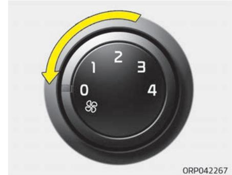
Zum Ausschalten des Gebläses drehen Sie den Reglerknopf für die Gebläsedrehzahl in die Stellung „0“.
