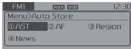
Wählen Sie AST (Automatisch speichern), um Sender mit gutem Empfang auf den Tasten **1**-**6** zu speichern. Falls keine Sender empfangen werden, wird die zuletzt eingestellte Frequenz wiedergegeben.
