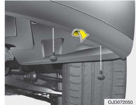
1. Ziehen Sie die Radabdeckung nach unten, indem Sie die Schrauben verdrehen.
