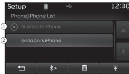
1. Connected Phone (Verbundenes Telefon): Das Gerät, zu dem aktuell eine Verbindung besteht.
