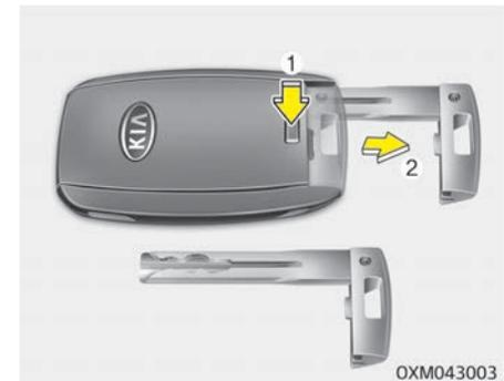
Wenn der Smart-Key nicht normal funktioniert, können Sie die Türen mit dem mechanischen Schlüssel verriegeln und entriegeln.
