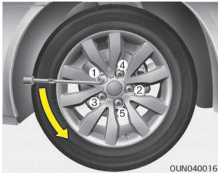
6. Lösen Sie alle Radmuttern um eine Umdrehung gegen den Uhrzeigersinn. Schrauben Sie noch keine Radmutter ab, bevor das Rad nicht so weit angehoben wurde, dass es den Boden nicht mehr berührt.
