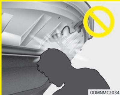
**Wenn Sie den Motorraum prüfen, achten Sie darauf, dass Ihr Kopf nicht durch den Sicherheitshaken der Motorhaube verletzt wird, der sich in der Motorhaube befindet.**
