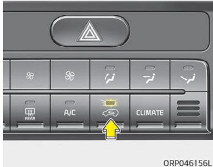
Mit dieser Schaltung können Sie zwischen der Zufuhr von Umgebungsluft (Frishluft) und der Umwälzung der im Fahrzeug befindlichen Luft (Umluft) wählen. Drücken Sie die Taste, um den Luftmodus zu ändern.
