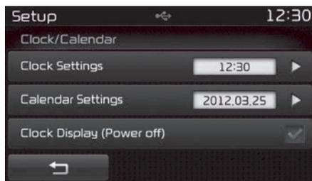
Diese Funktion wird verwendet, um eine Uhr auf dem Bildschirm anzuzeigen, wenn das Audiosystem ausgeschaltet ist.
