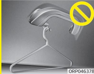
**Verwenden Sie den Kleiderhaken ausschließlich für Kleidung, nicht für Kleiderbügel oder andere harte Gegenstände. Legen Sie auch keine schweren, scharfen oder zerbrechlichen Gegenstände in die Taschen der Kleidung. Bei einem Unfall oder bei Auslösung des Kopfairbags kann es zur Beschädigung des Fahrzeugs oder zu Verletzungen kommen.**
