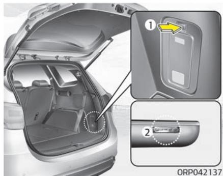
1. Die Fahrzeuglampe kann bei Bedarf abgetrennt und als Handlampe verwendet werden.
