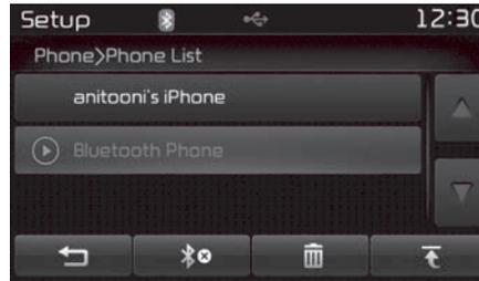
Wählen Sie aus der Liste der gekoppelten Telefone das Gerät aus, das Sie löschen möchten, und drücken Sie die Taste **Trash**.
