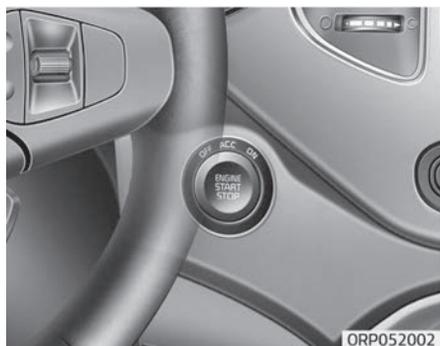
Immer wenn die vordere Tür geöffnet wird, wird die Beleuchtung des Knopfs ENGINE START/STOP (Motorstartknopf) von einer Komfortschaltung eingeschaltet. Das Licht erlischt nach etwa 30 Sekunden, nachdem die Tür geschlossen wurde. Erlischt ebenfalls sofort, wenn die Diebstahlwarnanlage aktiviert wird.
