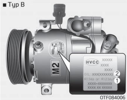
Die Kennzeichnung des Klimaanlagenkompressors enthält Informationen über die Art des Kompressors, mit dem Ihr Fahrzeug ausgestattet ist, d. h. Modell, Herstellerartikelnummer, Produktionsnummer, Kältemittel (1) und Kältemittelöl (2).
