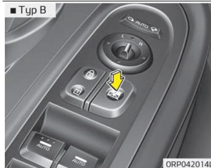
Der Fahrer kann die Fensterheberschalter der hinteren Türen deaktivieren, indem er den Fensterheber-Sperrschalter in die Verriegelungsposition drückt (nach unten).
