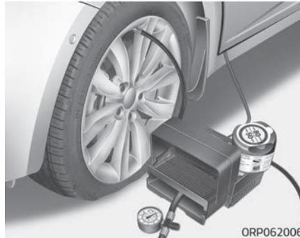
1. Entfernen Sie den Aufkleber mit der Angabe der Höchstgeschwindigkeit (1) von der Dichtmittelflasche (2) und bringen Sie ihn gut sichtbar im Fahrzeug an, z. B. auf dem Lenkrad, um den Fahrer daran zu erinnern, nicht zu schnell zu fahren.
