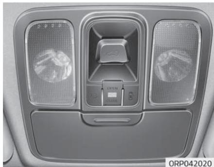
Wenn Ihr Fahrzeug mit einem Schiebedach ausgestattet ist, können Sie das Schiebedach über die Schiebedachhebel in der Dachkonsole aufstellen oder auf-schieben.
