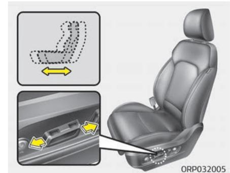
1. Drücken Sie den Steuerschalter nach vorn oder nach hinten, um den Sitz in die gewünschte Position zu bewegen.
