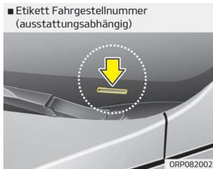
Die Fahrzeug-Identifizierungs-Nummer (FIN) ist auch auf dem Typenschild an der Oberseite des Armaturenbretts angegeben. Die Nummer auf dem Typenschild kann von außen bequem durch die Windschutzscheibe abgelesen werden.
