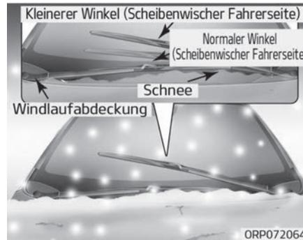
Wenn die Funktion des Wischerblatts auf der Beifahrerseite durch abgelagerten Schnee an der oberen Abdeckung behindert wird, wird der Arbeitswinkel des Wischerblatts auf der Fahrerseite reduziert, damit die beiden Wischerblätter nicht kollidieren. Während der Verwendung des reduzierten Wischerblattwinkels stoppt das Wischerblatt auf der Fahrerseite in einer anderen Position.
