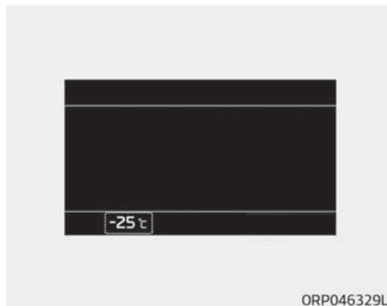
Dieses Messgerät zeigt die aktuelle Außenlufttemperatur in Schritten von 1 °C an.
