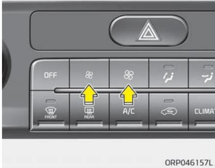
Durch Drücken der Gebäsedrehzahl-taste kann die gewünschte Gebäsedrehzahl eingestellt werden.
