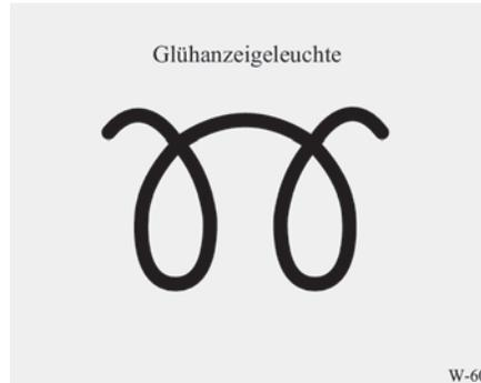
3. Drehen Sie den Zündschlüssel zum Vorgeglühen in die Zündschlossstellung ON. Die Vorgeglüh-Kontrollleuchte leuchtet daraufhin auf.
