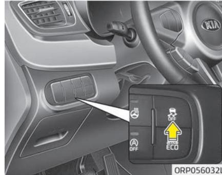
Die elektronische Stabilitätskontrolle (ESC) dient dazu, das Fahrzeug bei Kurvenfahrten bzw. Ausweichmanövern in einem stabilen Zustand zu halten. Die ESC vergleicht den Lenkradeinschlag mit der tatsächlichen Bewegung des Fahrzeugs. Die ESC kann einzelne Räder abbremsen und greift in die Motorsteuerung ein, wenn das Fahrzeug stabilisiert werden muss.
