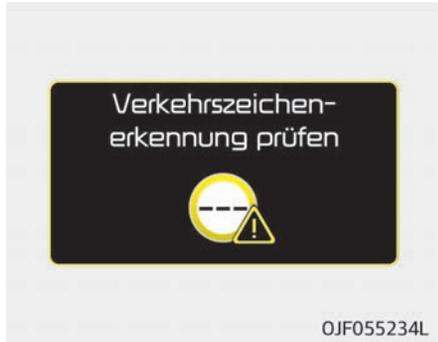
Wenn SLIF nicht ordnungsgemäß funktioniert, erscheint einige Sekunden lang diese Warnmeldung. Nachdem die Warnmeldung nicht mehr angezeigt wird, leuchtet die Hauptwarnleuchte.
