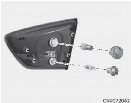
1. Bauen Sie die Lampenfassung aus dem Leuchtengehäuse aus, indem Sie die Fassung gegen den Uhrzeigersinn drehen, bis ihre Rastnasen auf die Gehäuseaussparungen ausgerichtet sind.
