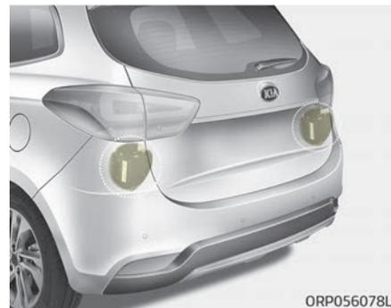
Die Sensoren befinden sich im hinteren Stoßfänger.
