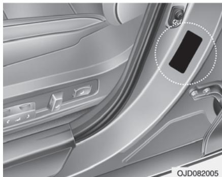
Alle Spezifikationen (Größen und Druckwerte) finden Sie auf einem Aufkleber am Fahrzeug.
