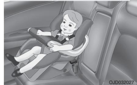
Für Kleinkinder und Babys muss ein Kinderrückhaltesystem verwendet werden. Das Kinderrückhaltesystem sollte die entsprechende Größe für das Kind haben und sollte gemäß den Anweisungen des Herstellers eingebaut werden.
