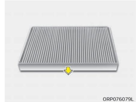
4. Ersetzen Sie den Luftfilter der Klimaanlage.
