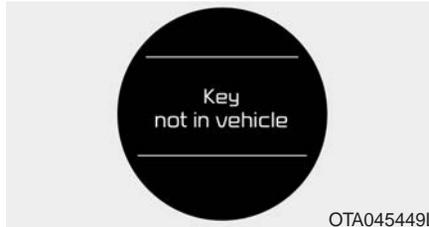
Wenn sich der Smartkey nicht im Fahrzeug befindet und eine Tür geöffnet oder geschlossen wird, während sich der Start/Stop-Knopf in der Stellung ACC, ON oder START befindet, erscheint dieser Warnhinweis auf dem LCD-Display. Ferner ertönt fünf Sekunden lang ein Akustiksignal, wenn sich der Smartkey nicht im Fahrzeug befindet und die Tür geschlossen wird.
