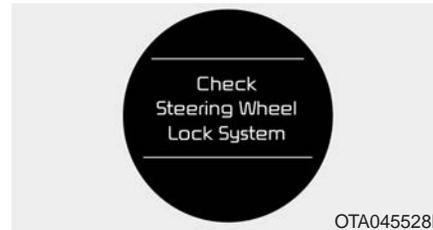
Falls die Lenkradsperre nicht ordnungsgemäß einrastet, wenn der Start/Stop-Knopf in die Stellung OFF (AUS) wechselt, erscheint etwa zehn Sekunden lang dieser Warnhinweis auf dem LCD-Display. Ferner ertönt ein dreisekündiges Warnsignal und es blinkt etwa zehn Sekunden lang die Kontrollleuchte des Start/Stop-Knopfs.
