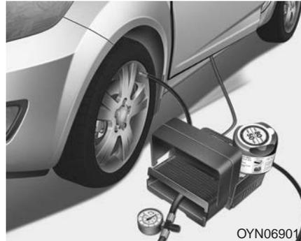
6. Vergewissern Sie sich, dass der Kompressor ausgeschaltet ist (Schalterstellung 0).
