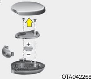
Die Fernbedienung enthält eine 3V Lithium-Batterie, die normalerweise über mehrere Jahre nicht ausgewechselt werden muss. Wenn die Batterie ersetzt werden muss, gehen Sie wie folgt vor:
