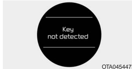
Wenn sich der Smart-Key nicht im Fahrzeug befindet oder nicht erkannt wird und Sie den Start/Stop-Knopf drücken, erscheint 10 Sekunden lang dieser Warnhinweis auf dem LCD-Display. Außerdem blinkt zehn Sekunden lang die Kontrollleuchte der Wegfahrsperre.
