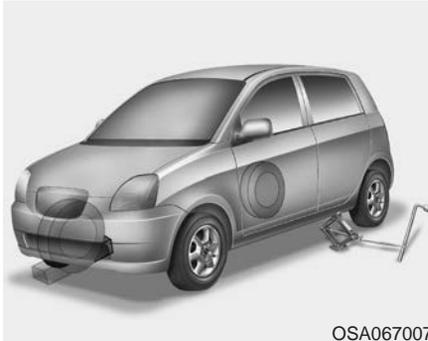
4. Nehmen Sie den Radmutter-schlüssel, den Wagenheber, die Wagenheberkurbel und das Ersatzrad aus dem Fahrzeug.
