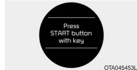
Wenn Sie den Start/Stop-Knopf drücken, während der Warnhinweis "Key is not detected" (Schlüssel nicht erkannt) angezeigt wird, erscheint zehn Sekunden lang die Meldung "Press START button with Key" (Startknopf mit Schlüssel drücken) auf dem LCD-Display. Außerdem blinkt zehn Sekunden lang die Kontrollleuchte der Wegfahrsperre.
