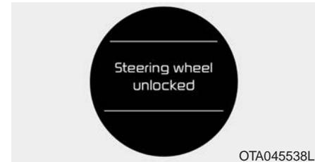
Falls die Lenkradsperre nicht normal einrastet, wenn der START/STOP-Knopf in die Stellung OFF (AUS) wechselt, erscheint 10 Minuten lang die Warnmeldung auf dem LCD-Display.
