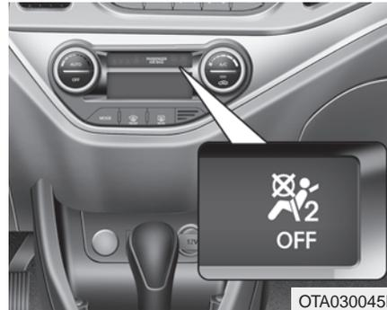
**Kontrollleuchte "Beifahrer-Airbag OFF (AUS)"**
