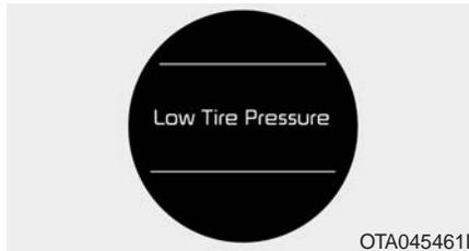
Die Reifenluftdruck-Warnleuchte leuchtet auf, wenn ein oder mehrere Reifen einen deutlich zu geringen Luftdruck aufweisen.
