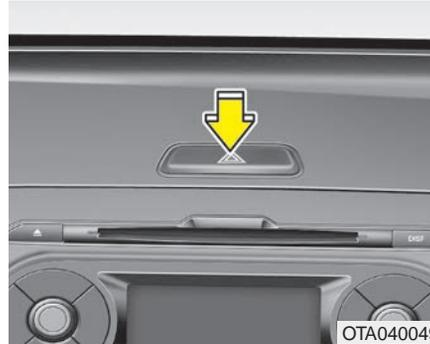
Die Warnblinker müssen immer eingeschaltet werden, wenn Sie es für notwendig halten, dass das Fahrzeug in einer kritischen Situation abgestellt wird. Wenn ein Not-Stopp notwendig ist, fahren Sie immer soweit wie möglich von der Straße weg.
