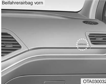
Zweck des SRS-Systems ist es, dem Fahrer und/oder dem vorderen Beifahrer im Fall einer Frontalkollision mit einer bestimmten Stärke erweiterten Schutz, zusätzlich zu dem Schutz, den die Sicherheitsgurte bieten, zur Verfügung zu stellen.
