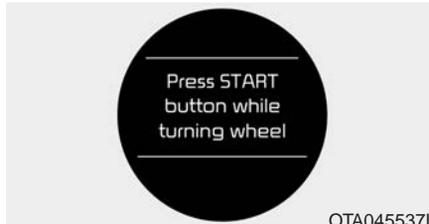
Wenn sich das Lenkrad nicht normal entsperren lässt, während der Start/Stop-Knopf gedrückt wird, erscheint etwa zehn Sekunden lang dieser Warnhinweis auf dem LCD-Display. Ferner erklingt ein einzelner Warnton und es blinkt etwa zehn Sekunden lang die Kontrollleuchte des Start/Stop-Knopfs.
