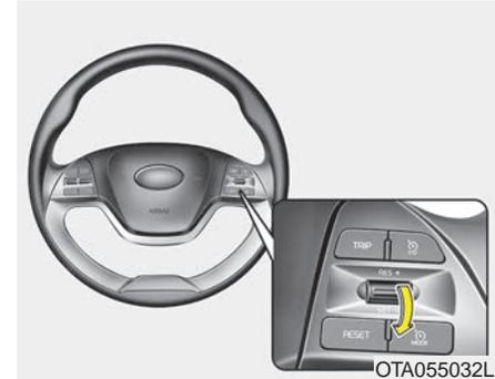
3. Bewegen Sie den Hebel nach unten (in Richtung SET-) und lassen Sie ihn bei der gewünschten Geschwindigkeit los. Daraufhin leuchtet die Anzeige „Cruise Set“ (Sollgeschwindigkeit eingestellt) auf. Lassen Sie gleichzeitig auch das Gaspedal los. Die eingestellte Geschwindigkeit wird nun automatisch beibehalten.
