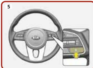
Tempomat-Steuerung mit der Abbruchtaste (O) unterbrechen
