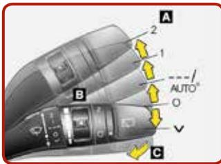
**A:** Wischergeschwindigkeitssteuerung (vorn)
