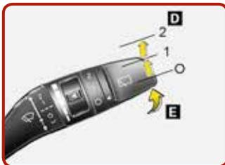
**D:** Steuerung für Heckscheibenwischer/-waschanlage
