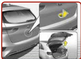
**Öffnen der Heckklappe [4]**
