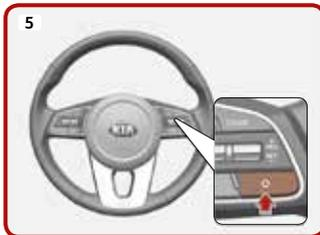
Tempomat-Steuerung mit der Abbruchtaste (O) unterbrechen
