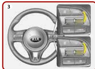
Hebel nach oben zur Position RES+ drücken, um die eingestellte Tempomat-Geschwindigkeit zu erhöhen
