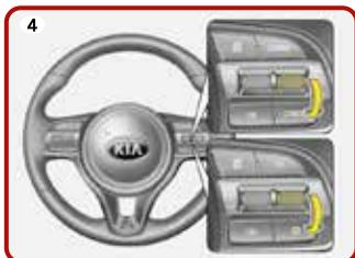
Hebel nach unten zur Position SET- ziehen, um die eingestellte Tempomat-Geschwindigkeit zu verringern
