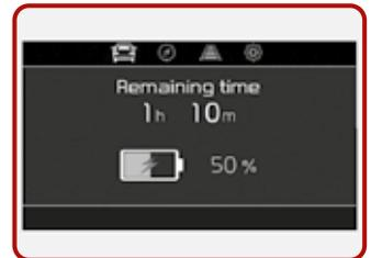
Die geschätzte Ladedauer wird auf dem Kombiinstrument angezeigt.
