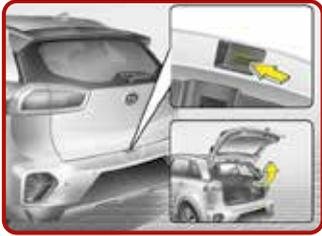
Öffnen der Heckklappe [5]
