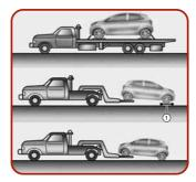
Wenn das Fahrzeug von einem Abschleppwagen ohne Nachläufer abgeschleppt wird, müssen immer die Vorderräder angehoben werden, nicht die Hinterräder.
