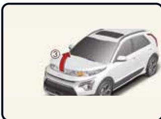
Haubenentriegelungshebel (1) ziehen. Entriegelungshebel der zweiten Verriegelungsstufe (2) nach links drücken. Motorhaube (3) anheben.
