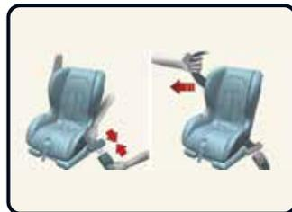
Befestigung eines Kinderrückhaltesystems mit Dreipunktgurt [4]
