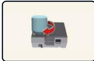
Mit dem Tire Mobility Kit bleiben Sie auch nach einer punktuellen Reifenpanne mobil. Nachdem Sie sich davon überzeugt haben, dass der Reifen ordnungsgemäß abgedichtet wurde, können Sie mit dem Reifen vorsichtig und mit einer maximalen Geschwindigkeit von 80 km/h bis zu 200 km weiterfahren, um eine Werkstatt zu erreichen, wo der Reifen ersetzt werden kann.
