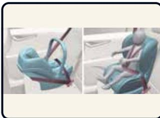
In Fahrtrichtung/entgegen der Fahrtrichtung befestigtes Kinderrückhaltesystem [4]
