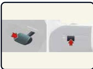
Um die Tempomatsteuerung vorübergehend zu unterbrechen, treten Sie auf das Bremspedal oder drücken Sie den Schalter (||○).
