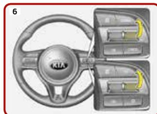
Hebel nach oben zur Position RES + ziehen, um die Tempomat-Steuerung wieder aufzunehmen
