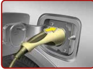
4. Entfernen Sie eventuelle Staubablagerungen von dem Aufladeverbinder und der Aufladebuchse.
