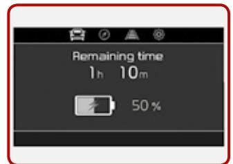
Auf dem Kombiinstrument angezeigte geschätzte Ladedauer
