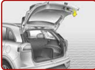
Schließen der Heckklappe [5]
