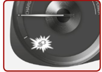
6. Überprüfen Sie, ob die Kontrollleuchte für den Anschluss des Aufladekabels im Kombiinstrument leuchtet. Der Aufladevorgang beginnt nur, wenn die Kontrollleuchte leuchtet. Wenn der Aufladeverbinder nicht richtig angeschlossen ist, schließen Sie das Aufladekabel zur Aufladung erneut an.
