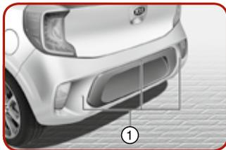
Der hintere Parkassistent unterstützt den Fahrer beim Rückwärtsfahren, indem das System einen Warnton ausgibt, wenn die hinteren Parksensoren ① innerhalb von 120 cm hinter dem Fahrzeug ein Hindernis erkennen.
