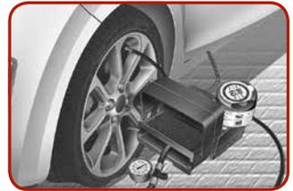
Mit dem Tire Mobility Kit bleiben Sie auch nach einer punktuellen Reifenpanne mobil. Nachdem Sie sich davon überzeugt haben, dass der Reifen ordnungsgemäß abgedichtet wurde, können Sie mit dem Reifen vorsichtig und mit einer maximalen Geschwindigkeit von 80 km/h bis zu 200 km weiterfahren, um eine Werkstatt oder einen Reifenhandel zu erreichen, wo der Reifen ersetzt werden kann.
