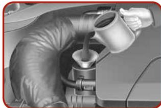
5. Ziehen Sie den Messstab wieder heraus und prüfen Sie den Füllstand. Wenn die Flüssigkeit in der Nähe der Markierung L (leer) steht, füllen Sie Öl nach, bis die Markierung F (voll) erreicht ist. **Füllen Sie nicht zu viel Öl nach.**
