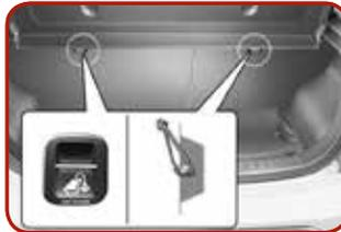
Kinderrückhaltesystem mit einem Halteband an einem oberen Ankerpunkt\* im Fahrzeug sichern.
