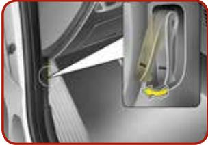
1. Ziehen Sie den Entriegelungshebel, um die Motorhaube zu entriegeln.
