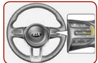
Ziehen Sie den Hebel nach oben zur Position RES+, um die Tempomat-Steuerung wieder aufzunehmen.
