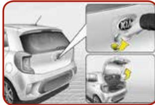
Heckklappe manuell öffnen
