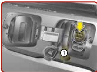
4. Ziehen Sie die Entriegelungslasche ①, um die Abdeckung der Wechselstrom-Aufladebuchse zu öffnen und entfernen Sie jeglichen Staub vom Aufladeverbinder und der Aufladebuchse.
