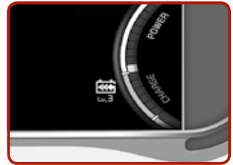
Die gewählte regenerative Bremsstufe wird auf dem Kombiinstrument angezeigt. Die Anfangseinstellung der regenerativen Bremsstufe hängt vom gewählten Fahrmodus ab.
