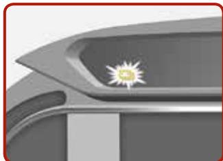
**Warnleuchte für niedrigen Batterieladestand [1]** – Das Fahrzeug kann abhängig von verschiedenen Faktoren noch 20 bis 30 km fahren.
