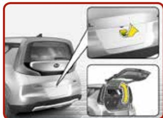
Öffnen der Heckklappe [5]
