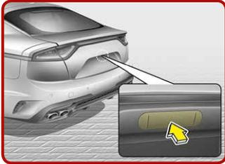
**Öffnen der Heckklappe [4]**
