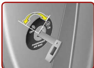
Schalter Beifahrer-Frontairbag ON/OFF [3]
