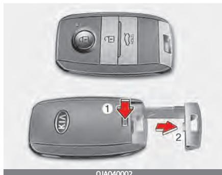
Um den mechanischen Schlüssel zu entfernen, drücken und halten Sie die Freigabetaste (1) und ziehen Sie den mechanischen Schlüssel (2) heraus.
