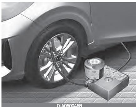
Das aus einem Kompressor und Dichtmittel bestehende System dichtet effektiv und bequem die meisten punktuellen Undichtigkeiten von PKW-Reifen ab, die durch Nägel oder ähnliche Gegenstände hervorgerufen wurden, und es pumpt den Reifen auf.
