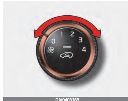
den Lüfter kann nur bei eingeschalteter Zündung bedient werden.
