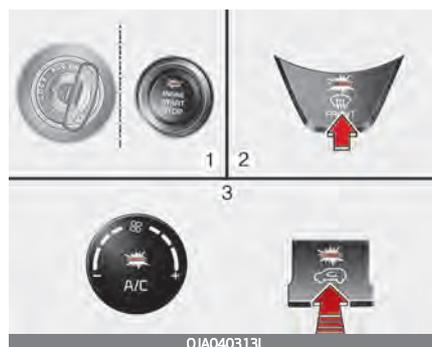
Die Kontrollleuchte für die Frischluft-/Umlufttaste blinkt 3 Mal. Dies zeigt an, dass die Beschlagfrei-Logik abgebrochen wird oder wieder in den programmierten Status zurückkehrt.
