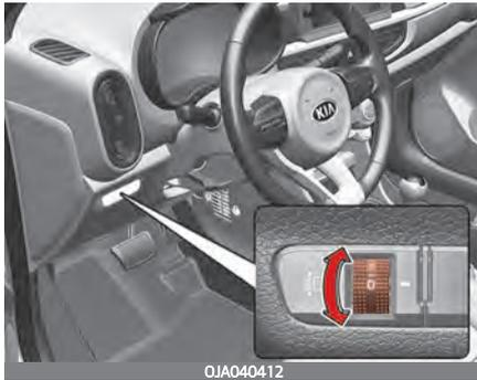
Um die Leuchtweite entsprechend der Anzahl der Insassen und dem zugeladenen Gewicht im Laderaum einzustellen, drehen Sie das Stellrad.
