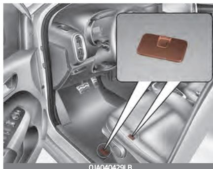
Wird der Fußbodenbelag vorn durch eine Bodenmatte ergänzt, müssen Sie die Bodenmatte mit den Verankerungen im Fahrzeug fixieren. Auf diese Weise rutscht die Bodenmatte nicht nach vorn.
