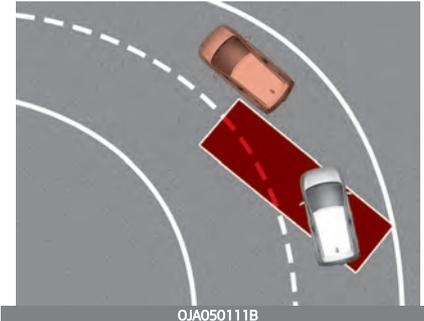
Das Totwinkel-Erkennungssystem funktioniert nicht ordnungsgemäß, wenn Sie auf einer kurvenreichen Straße fahren. Das System kann das Fahrzeug in der gleichen Fahrspur erkennen.
