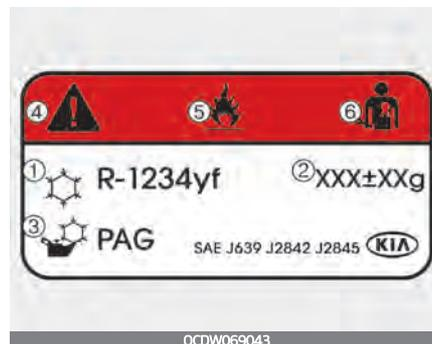
\* Die tatsächliche Kennzeichnung des Kältemittels der Klimaanlage in Ihrem Fahrzeug kann von dieser Abbildung abweichen.
