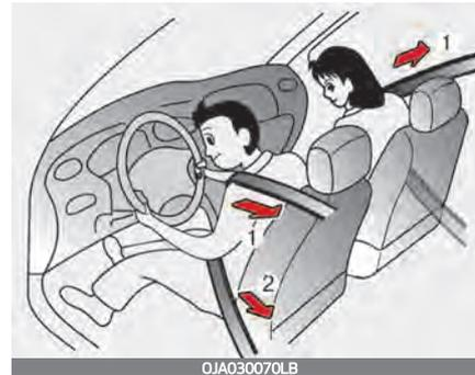
Wenn das Fahrzeug stark abgebremst wird oder ein Insasse versucht, sich zu schnell nach vorn zu beugen, rastet die Gurttrolle ein. Bei bestimmten frontalen Kollisionen wird der Gurtstraffer aktiviert und er zieht den Gurt strammer gegen den Körper des Insassen.
