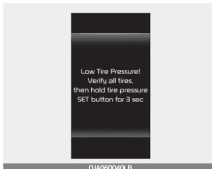
Überprüfen Sie den Druck aller Reifen und pumpen Sie sie gegebenenfalls nach dem angegebenen Verfahren auf den empfohlenen Reifendruck auf. Ersetzen oder reparieren Sie gegebenenfalls die Reifen.
