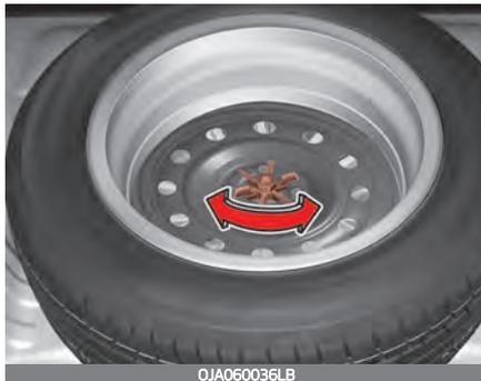
Wenn sich die Flügelschraube zur Radbefestigung schwer von Hand lösen lässt, können Sie sie problemlos mit dem Griff des Wagenhebers lösen.
