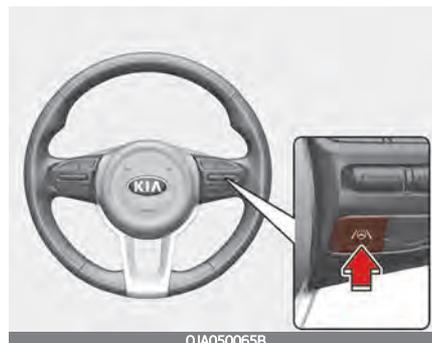
Halten Sie, wenn der Start-/Stopp-Knopf in Position ON steht, die Taste für den Spurhalteassistenten (☞) am Lenkrad gedrückt, um den Spurhalteassistenten auszuschalten. Halten Sie die Taste erneut gedrückt, um das System einzuschalten.
