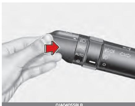
Um das Fernlicht einzuschalten, drücken Sie den Hebel bei eingeschaltetem Scheinwerfer nach vorn. Ziehen Sie den Hebel nach hinten, um das Abblendlicht einzuschalten.
