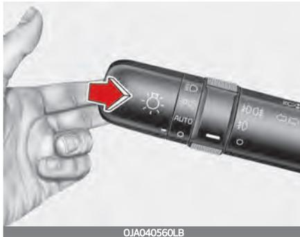
Um die Lichttupe zu betätigen, ziehen Sie den Lichtschalterhebel auf sich zu. Wenn Sie ihn loslassen, kehrt er in seine ursprüngliche Stellung (Fahrlicht) zurück. Um die Lichttupe bedienen zu können, muss das Licht nicht eingeschaltet sein.
