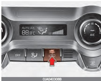
Mit dieser Schaltung können Sie zwischen der Zufuhr von Umgebungsluft (Frischluff) und der Umlüftung der im Fahrzeug befindlichen Luft (Umluft) wählen.
