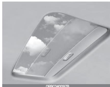
Der Sonnenschutz wird automatisch mit dem Schiebedach geöffnet. Ziehen Sie den Sonnenschutz manuell nach vorn, um ihn zu schließen.
