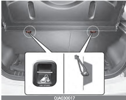
1. Führen Sie das obere Halteband des Kinderrückhaltesystems über die Rücksitzlehne. Befolgen Sie bei der Verlegung des oberen Haltebandes die Anweisungen des Kindersitzherstellers.
