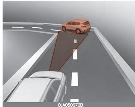
Der Frontalkollisions-Vermeidungsassistent erkennt bei der Fahrt auf einer kurvigen Straße möglicherweise ein Fahrzeug in der benachbarten Spur oder außerhalb der Spur. In diesem Fall kann die Funktion den Fahrer unnötigerweise alarmieren und die Bremse betätigen.
