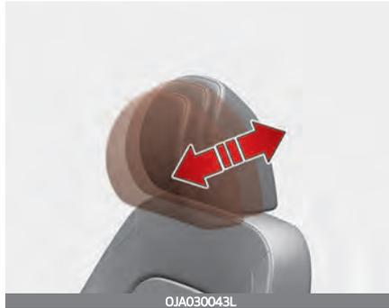
Die Kopfstütze kann nach vorn in 4 verschiedene Stellungen gebracht werden, indem Sie die Kopfstütze in die gewünschte Stellung nach vorn ziehen. Um die Kopfstütze in die hinterste Position zu bringen, ziehen Sie sie zunächst ganz nach vorn und lassen Sie sie dann los. Stellen Sie die Kopfstütze so ein, dass Kopf und Nacken in geeigneter Weise abgestützt werden.
