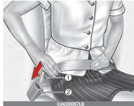
Bei einem statischen 2-Punkte-Gurt muss die Länge manuell eingestellt werden, damit der Gurt eng an Ihrem Körper anliegt. Legen Sie den Gurt an und ziehen Sie an dem losen Gurtende, um das Gurtband zu straffen.
