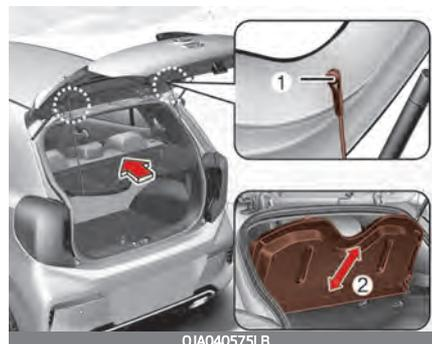
1. Entfernen Sie die Riemen (1) an beiden Seiten der Kofferraumabdeckung.
