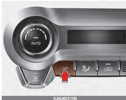
Drücken Sie die Taste OFF, um die Klimaanlage auszuschalten. Die Frischluft-/Umluftschaltung können jedoch weiterhin bedient werden, solange die Zündung eingeschaltet ist.
