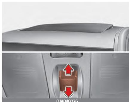
Drücken Sie zum Öffnen des Schiebedachs den Hebel des Schiebedachs nach oben, bis das Schiebedach sich in der gewünschten Position befindet.
