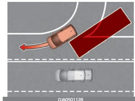
Das Totwinkel-Sicherheitssystem funktioniert möglicherweise nicht richtig, wenn sich Straßen gabeln oder zusammengeführt werden. In bestimmten Fällen erzeugen sie Fehler.
