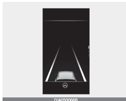
Wenn das vorausfahrende Fahrzeug oder beide Fahrbahnmarkierungen erkannt werden und Ihre Fahrzeuggeschwindigkeit unter 180 km/h liegt, leuchtet die grüne Anzeige (🟢) des Kombiinstruments auf, und das System hält das Fahrzeug in der Spur, indem es das Lenkrad steuert.
