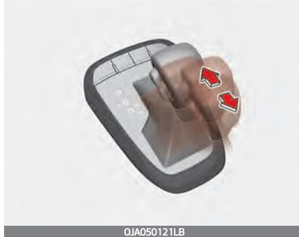
Den Handschaltmodus können Sie sowohl im Stand als auch während der Fahrt wählen. Bewegen Sie dazu den Wählhebel aus der Position D (Fahrstufe) in die manuelle Schaltgasse (M). Um wieder in den Betrieb im Fahrbereich (D) zurückzuschalten, drücken Sie den Wählhebel zurück in die Hauptschaltgasse. Im manuellen Schaltmodus können Sie die gewünschten Gänge für die momentanen Fahrbedingungen wählen, indem Sie den Wählhebel nach vorn drücken oder nach hinten ziehen.
