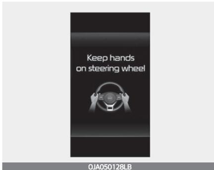
Wenn der Fahrer die Hände für einige Sekunden vom Lenkrad nimmt, erscheint die Warnmeldung „Hände auf das Lenkrad legen“ (oder „Hände am Lenkrad lassen“) auf dem Kombiinstrument, und es ertönt ein immer lauterer Warnton.
