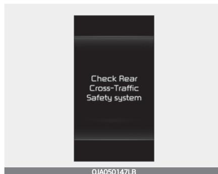
Wenn das hintere Querverkehr-Erkennungssystem nicht richtig funktioniert, erscheint die Warnmeldung „hinteres Querverkehr-Erkennungssystem prüfen“ auf dem Kombiinstrument, und das System schaltet sich automatisch aus oder wird in seiner Funktionalität eingeschränkt. Es wird empfohlen, Ihr Fahrzeug von einem Kia-Vertragshändler/Servicepartner überprüfen zu lassen.
