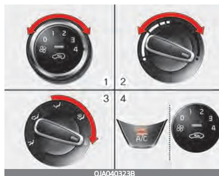
Wenn die Aktivierung der Klimaanlage und des Frischluftmodus nicht automatisch erfolgt, betätigen Sie die entsprechende Taste manuell.
