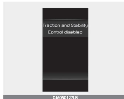
Drücken Sie kurz die ESC OFF-Taste (ESC OFF-Kontrollleuchte leuchtet und Meldung erscheint). In diesem Zustand funktioniert die Motorkontrollfunktion nicht. Mit anderen Worten: Die Traktionskontrolle funktioniert nicht, aber die Bremssteuerfunktion ist aktiv.
