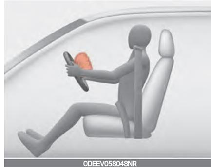
Die beiden Airbagmodule befinden sich in der Mitte des Lenkrads und im Armaturenbrett über dem Handschuhfach. Wenn das SRSCM einen ausreichend schweren Frontalaufprall erkennt, löst es automatisch die vorderen Airbags aus.
