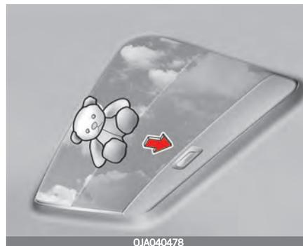
Wenn beim automatischen Schließen des Schiebedachs ein Gegenstand oder Körperteil erkannt wird, fährt das Schiebedach oder Sonnenschutz zurück und bleibt danach stehen.
