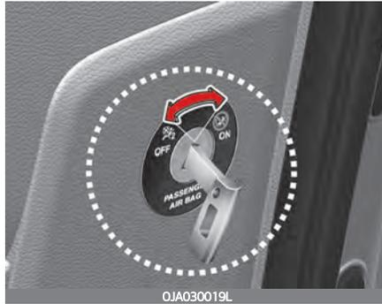
Wenn ein Kinderrückhaltesystem auf dem Beifahrersitz installiert ist oder dieser Sitz nicht besetzt ist, kann der Beifahrerairbag mit dem Schalter „Beifahrer-Frontairbag ON/OFF“ deaktiviert werden.
