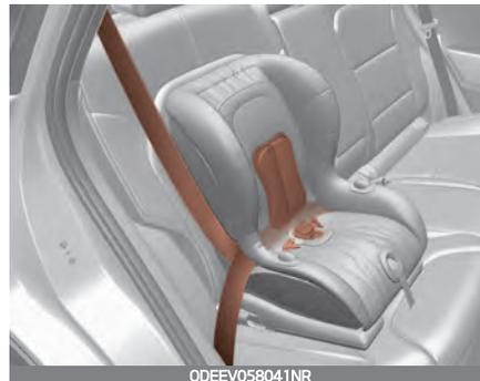
1. Legen Sie das Rückhaltesystem auf den Rücksitz und führen Sie den Dreipunktgurt entsprechend der Herstelleranweisungen durch das Rückhaltesystem hindurch oder um das Rückhaltesystem herum. Vergewissern Sie sich, dass das Gurtband nicht verdreht ist.
