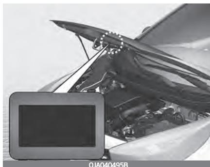
Der Kältemittelaufkleber befindet sich an der Unterseite der Haube.
