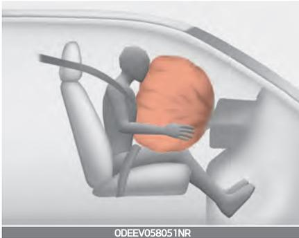
Nach der vollständigen Ausdehnung lässt der Airbag seinen Druck sofort wieder ab und ermöglicht dem Fahrer freie Sicht nach vorn und die Möglichkeit, die Lenkung und andere Einrichtungen zu bedienen.
