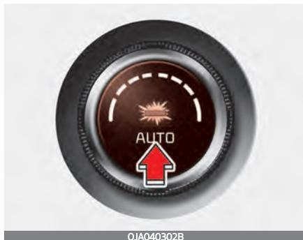
1. Drücken Sie die AUTO-Taste. Lüftungsmodi, Lüfterdrehzahl sowie Frischluft-/Umluftbetrieb der Klimaanlage werden automatisch nach der eingestellten Temperatur gesteuert.
