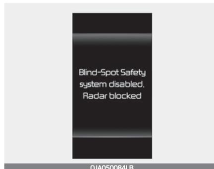
Wenn der hintere Stoßfänger um das Heckradar oder den Sensor mit Fremdkörpern wie Schnee oder Regen bedeckt ist oder ein Anhänger oder Träger installiert ist, können sich die Erkennungseigenschaften verschlechtern, so dass die Funktion des Totwinkel-Sicherheitssystems vorübergehend eingeschränkt oder deaktiviert wird.
