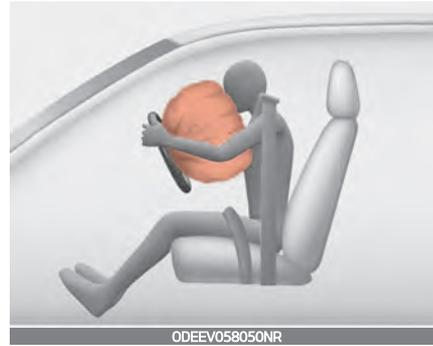
Ein vollständig aufgeblasener Airbag, in Verbindung mit einem ordnungsgemäß angelegten Sicherheitsgurt, verlangsamt die Vorwärtsbewegung des Fahrers oder Beifahrers und reduziert das Risiko von Kopf- und Brustverletzungen.
