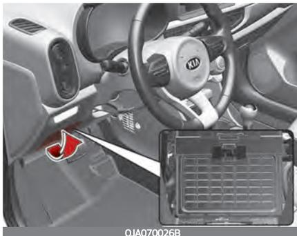
3. Ziehen Sie die vermutlich schadhafte Sicherung gerade aus ihrem Sockel. Verwenden Sie das Ausbauwerkzeug aus dem Hauptsicherungskasten im Motorraum.
