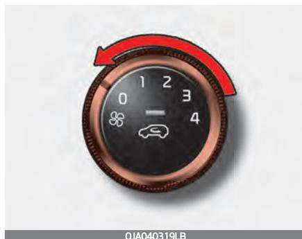
Zum Ausschalten des Gebläses drehen Sie den Reglerknopf für die Gebläsedrehzahl in die Stellung „0“.
