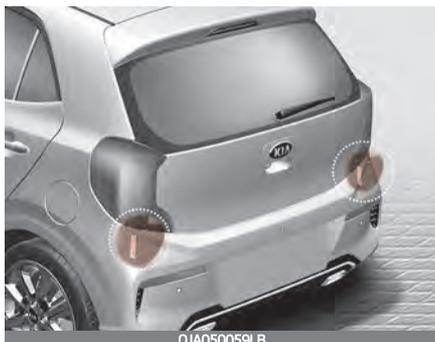
Die genaue Position des Detektors ist im Bild oben zu sehen.
