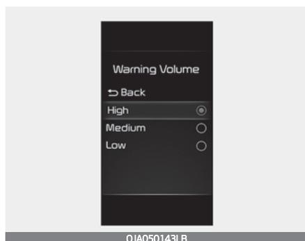
Wählen Sie, wenn der Start-/ Stopp-Knopf in Position ON steht, im Einstellungsmenü die Option „Fahrerassistenz“ → „Warnlautstärke“, um die Warnlautstärke für das hintere Querverkehr-Sicherheitssystem auf 'Hoch', 'Mittel' oder 'Niedrig' zu ändern.
