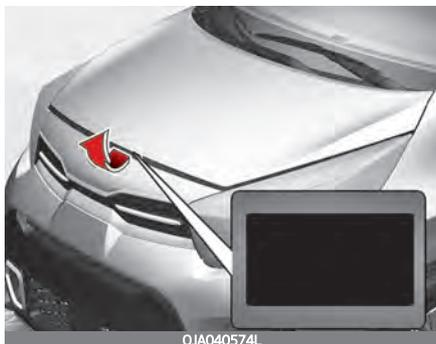
Der Kältemittelaufkleber befindet sich an der Unterseite der Haube.
