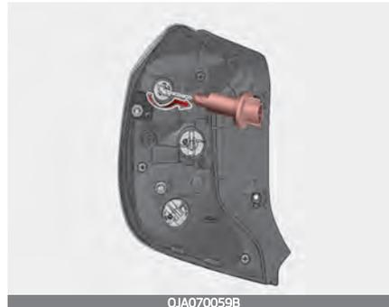
5. Bauen Sie die Lampenfassung aus dem Leuchtengehäuse aus, indem Sie die Fassung gegen den Uhrzeigersinn drehen, bis ihre Rastnasen auf die Gehäuseaussparungen ausgerichtet sind.
