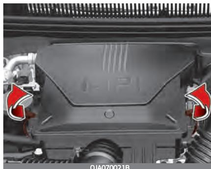
2. Bauen Sie die Abdeckung des Luftfilters aus.
