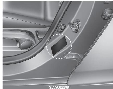
Der Aufkleber "Typengenehmigung" auf der Mittelsäule auf der Fahrerseite (oder Beifahrerseite) enthält die Fahrzeug-Identifizierungsnummer (FIN).
