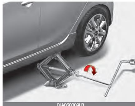
9. Lockern Sie die Radmuttern und drehen Sie sie mit der Hand von den Radbolzen. He- ben Sie das Rad von den Rad- bolzen und legen Sie es auf
