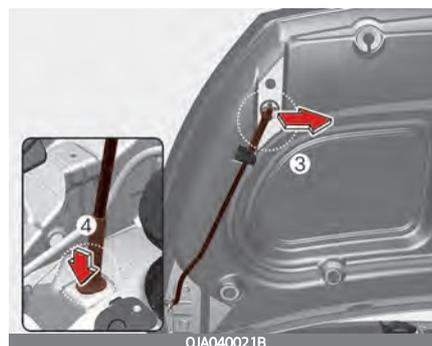
4. Stützen Sie die Motorhaube mit der Stützstange (4) ab.
