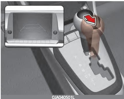
Die Rückfahrkamera wird beim Einschalten der Rückfahrleuchte aktiviert, wenn der Zündschalter auf ON und der Schalthebel in Position R (Rückwärtsgang) steht.
