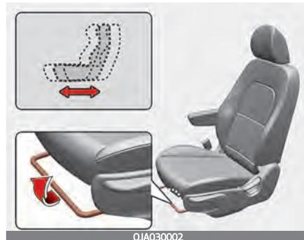
Stellen Sie den Sitz vor der Fahrt ein und stellen Sie sicher, dass er fest eingerastet ist, indem Sie versuchen, ihn ohne Anziehen des Hebels nach vorn oder hinten zu schieben. Wenn sich der Sitz bewegen lässt, ist er nicht ordnungsgemäß eingerastet.
