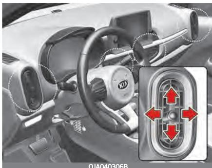
Die Düsen können separat mit dem horizontalen Stellrad geöffnet und geschlossen werden. Um die Öffnung zu schließen, drehen Sie den Regler nach unten in die maximale Position. Um die Öffnung zu öffnen, drehen Sie den Regler nach oben in die gewünschte Position.
