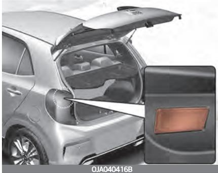
Die Kofferraumleuchte wird beim Öffnen der Heckklappe aktiviert.
