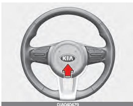
Drücken Sie zum Hupen das Hupensymbol auf dem Lenkrad. Prüfen Sie die Hupe regelmäßig, damit Sie sicher sein können, dass die Hupe in Ordnung ist.
