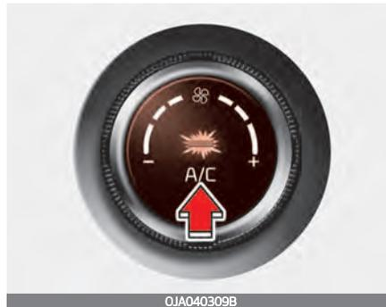
Drücken Sie die Taste A/C, um die Klimaanlage einzuschalten. Die Kontrollleuchte im Schalter leuchtet bei eingeschalteter Klimaanlage auf.
