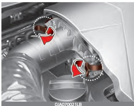
1. Lösen Sie die Befestigungsklammern des Luftfilterdeckels und entfernen Sie den Luftfilterschlauch.
