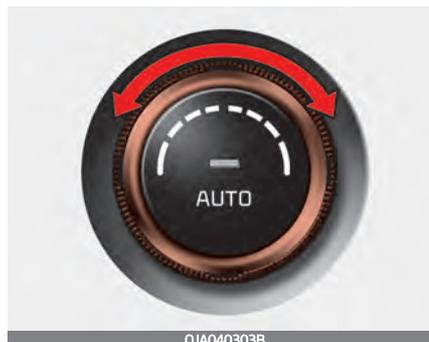
Durch Drehen des Temperaturreglers bis in die äußerste rechte Reglerstellung wird die maximale Temperatur (Hi) erreicht.
