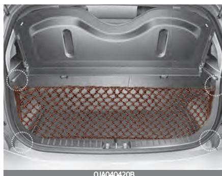
Um zu verhindern, dass sich das Ladegut unkontrolliert im Kofferraum bewegen kann, können Sie mit den 2 Haltern im Kofferraum ein Gepäcknetz befestigen.
