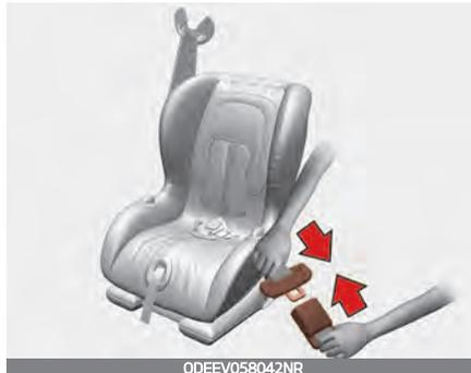
2. Schieben Sie die Schließzunge des Dreipunktgurts in das Gurtschloss. Achten Sie darauf, dass das Klickgeräusch deutlich hörbar ist. Positionieren Sie die Gurtschlosstaste so, dass sie im Notfall leicht erreichbar ist.
