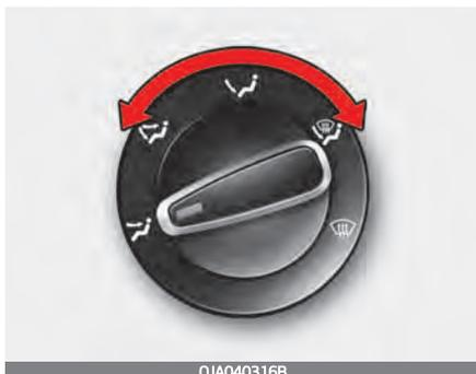
Der Modusschalter steuert die Richtung des Luftstroms im Belüftungssystem.
