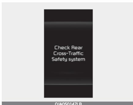
Wenn das hintere Querverkehr-Erkennungssystem nicht richtig funktioniert, erscheint die Warnmeldung „hinteres Querverkehr-Erkennungssystem prüfen“ auf dem Kombiinstrument, und das System schaltet sich automatisch aus oder wird in seiner Funktionalität eingeschränkt. Es wird empfohlen, Ihr Fahrzeug von einem Kia-Vertragshändler/Servicepartner überprüfen zu lassen.
