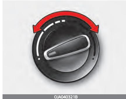
Mit dem Temperaturregler können Sie die Temperatur der Luft regeln, die vom Belüftungssystem strömt. Um die Temperatur im Fahrzeuginnenraum zu ändern, drehen Sie den Knopf nach rechts, um warme oder heiße Luft zu erhalten, und drehen Sie ihn nach links, um kühlere Luft zu erhalten.
