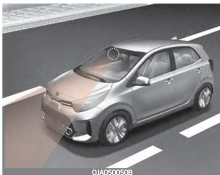
Die Frontkamera wird als Erkennungssensor verwendet, um Fahrbahnmarkierungen (oder Fahrbahnränder) zu erkennen.
