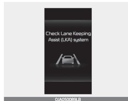
Wenn der Spurhalte-Assistent nicht richtig funktioniert, erscheint die Warnmeldung 'Spurhalte-Assistent (LKA) prüfen', und die gelbe 🚗-Kontrollleuchte am Kombiinstrument leuchtet auf. Lassen Sie die Anlage in diesem Fall von einer Fachwerkstatt überprüfen. Kia empfiehlt, sich an einen Kia-Vertragshändler/Servicepartner zu wenden.
