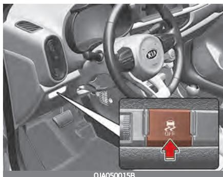
Die elektronische Stabilitätskontrolle (ESC) dient dazu, das Fahrzeug bei Kurvenfahrten bzw. Ausweichmanövern in einem stabilen Zustand zu halten. Die ESC vergleicht den Lenkradeinschlag mit der tatsächlichen Bewegung des Fahrzeugs.
