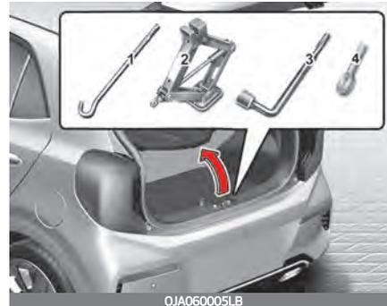
Heben Sie die Abdeckung im Kofferraumboden an, um an das Werkzeug zu gelangen.
