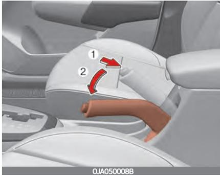
Um die Feststellbremse zu lösen, treten Sie erst auf das Pedal der Fußbremse und ziehen Sie den Hebel der Feststellbremse leicht an. Drücken Sie nun auf den Entriegelungsknopf (1) und halten Sie ihn gedrückt, während Sie den Hebel der Feststellbremse (2) nach unten herablassen.
