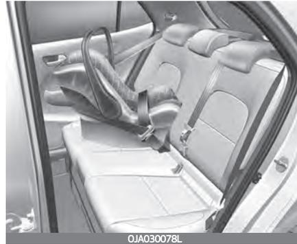
Ein Kinderrückhaltesystem entgegen der Fahrtrichtung hält das Kind so, dass der Rücken des Kindes in Fahrtrichtung zeigt. Das Haltegurtsystem fixiert das Kind. Bei einem Unfall bleibt das Kind in dem Kinderrückhaltesystem und eine Belastung der empfindlichen Nacken- und Rückenwirbel wird verringert.
