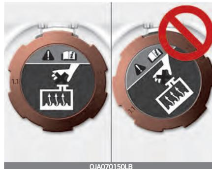
2. Stellen Sie sicher, dass die kleinen Vorsprünge im Kühlmitteldeckel sicher eingerastet sind.
