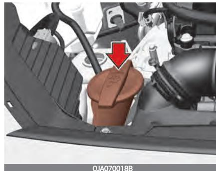
Der Vorratsbehälter ist transparent, sodass der Füllstand mit einem Blick erkennbar ist.
