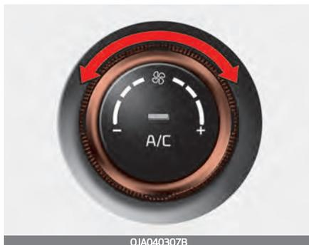
Durch den Lüfterdrehzahlregler kann die gewünschte Lüfterdrehzahl eingestellt werden.
