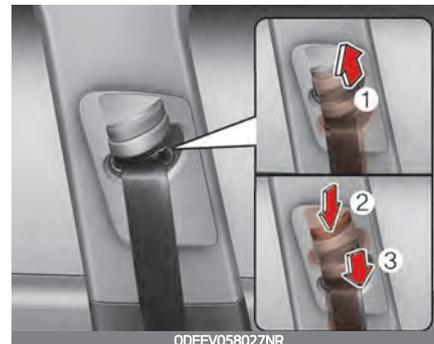
Geben Sie die Taste frei, um die Verankerung in ihrer Position zu sichern. Versuchen Sie den Einsteller zu verschieben, um sicherzustellen, dass er eingerastet ist.
