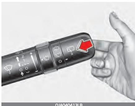
Ziehen Sie den Wischerhebel in der Schalterstellung OFF (0) leicht nach hinten, um Waschwasser auf die Windschutzscheibe zu sprühen und die Scheibenwischer 1-3 Mal wischen zu lassen.
