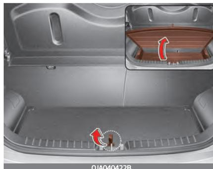
Erfassen Sie den Griff oben an der Abdeckung und heben Sie die Abdeckung damit an.
