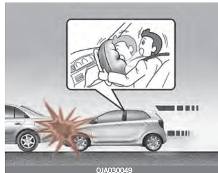
Frontairbags werden in der Regel bei einem Frontalaufprall ausgelöst. Die Auslösung hängt von der Intensität, der Geschwindigkeit und dem Aufprallwinkel ab.
