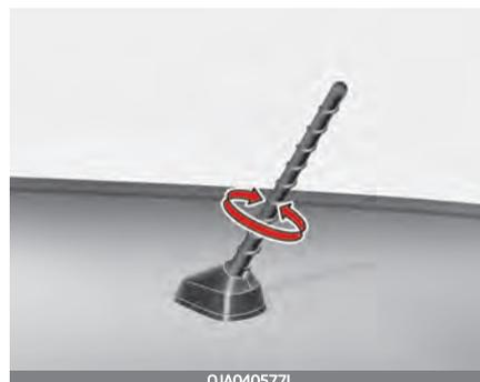
Ihr Fahrzeug nutzt eine Dachantenne für den Empfang von AM- und FM-Rundfunksignalen. Diese Antenne ist abbaubar.
