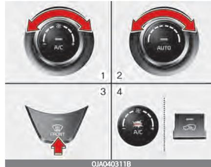
Wenn die Aktivierung der Klimaanlage und des Frischluftmodus nicht automatisch erfolgt, betätigen Sie die entsprechende Taste manuell. Wenn die Stellung
