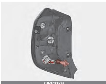
7. Setzen Sie eine neue Glühlampe in die Fassung ein und drehen Sie die Glühlampe, bis sie einrastet.
