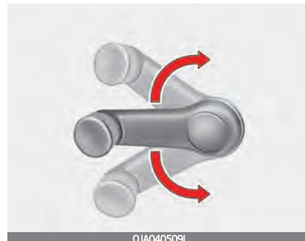
Drehen Sie die Fensterkurbel im Uhrzeigersinn oder gegen den Uhrzeigersinn, um das Fenster zu heben oder zu senken.
