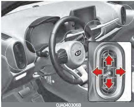
Die Lüftungsdüsen können separat mit dem Einstellrädchen geöffnet und geschlossen werden. Um die Öffnung zu schließen, drehen Sie den Regler nach unten in die maximale Position.
