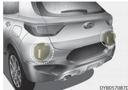
Die Sensoren befinden sich im hinteren Stoßfänger.
