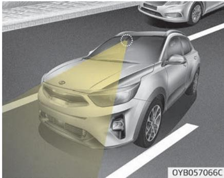
Das Spurhaltewarnsystem (LKA) erkennt die Fahrspurmarkierungen auf der Straße mit einer Frontkamera in der Windschutzscheibe und unterstützt den Fahrer beim Lenken, damit das Fahrzeug in der Fahrspur bleibt.
