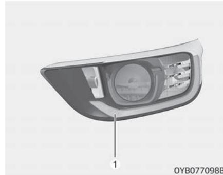
Wenn Positionslampe + Tagfahrlicht (1) nicht funktionieren, lassen Sie das Fahrzeug von einer Fachwerkstatt überprüfen.
