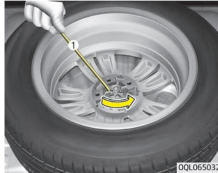
Wenn sich die Flügelschraube der Radbefestigung nur schwer von Hand lösen lässt, können Sie mit dem Griff des Wagenhebers lösen.
