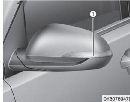
Wenn die Seitenblinkeuchte (LED) (1) nicht funktioniert, lassen Sie das Fahrzeug von einer Fachwerkstatt überprüfen.
