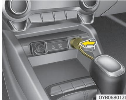
9. Schließen Sie den Kompressor mit dem Kabel und den Verbindern an die Fahrzeug-Steckdose an.
