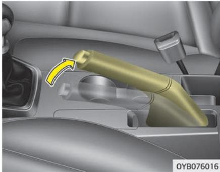
Prüfen Sie den Hebelweg der Feststellbremse, indem Sie die Anzahl der „Klicks“ zählen, die Sie beim Anziehen des Hebels aus der gelösten Stellung hören. Die Feststellbremse alleine sollte außerdem das Fahrzeug an einer relativ steilen Neigung sichern. Wenn der Hub größer oder kleiner als vorgegeben ist, lassen Sie die Anlage von einer Fachwerkstatt überprüfen. Kia empfiehlt den Besuch eines Kia-Händlers/Servicepartners.
