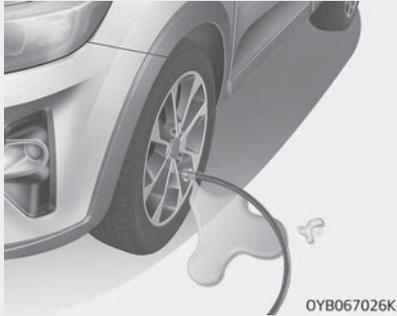
**Montieren Sie den Dichtmitteleinfüllschlauch sicher am Ventil. Andernfalls kann Dichtmittel zurückfließen und möglicherweise den Einfüllschlauch verstopfen.**
