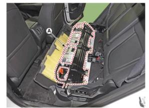
C'è un condotto di ingresso e uscita (A) e il sistema batteria HEV.
