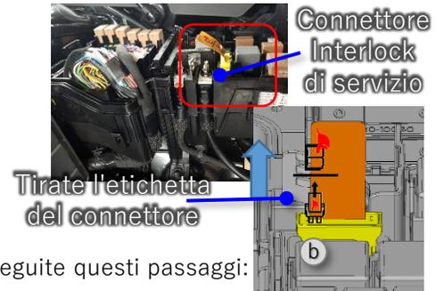
■ Per scollegare la batteria da 12V e la batteria ad Alta Tensione, seguite questi passaggi:
