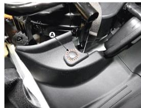
Rimuovete l'elemento di fissaggio (A) della modanatura laterale.
